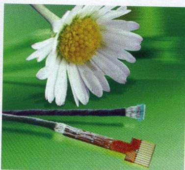
**Рис.3.** Кабельная сборка для эндоскопического оборудования
