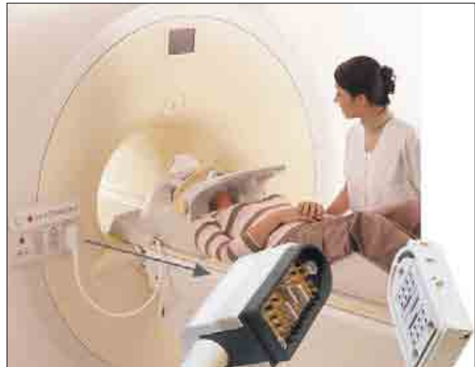
Рис. 2. Это специальное решение образует интерфейс между МРТ и индивидуальными нателными катушками
