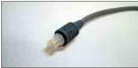
Рис. 4. Специальный соединитель как альтернатива ODU MEDI-SNAP
