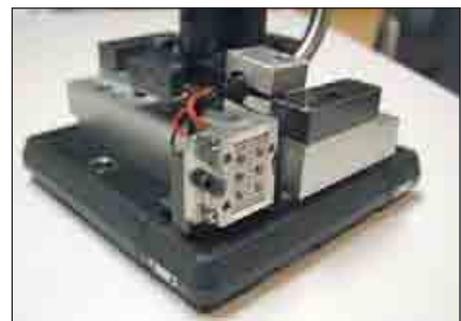
Рис. 8. Разъем ODU MAC на испытательном стенде (для проверки инжекторных клапанов)
