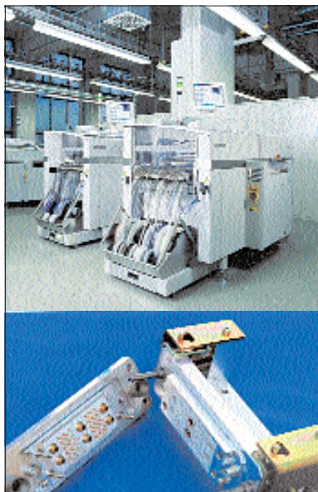
Рис. 1. ODU MAC — интерфейс между загрузочным устройством и машиной (для вращения катушек в подающем устройстве используются низкие уровни мощности и сигналов)
